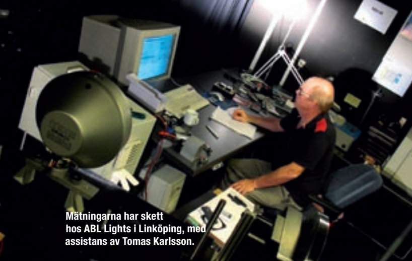
Mätprogrammet används för att centrera ljusbilden och sedan skanna av den i horisontalplanet, i 750 mätpunkter.
